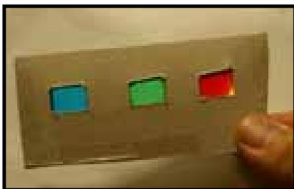
Figure 1 • Filtres rouge, vert et bleu (RVB) dans un support en carton.
